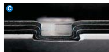
Steel 0.7 mm Adhesive 2 x steel 0.7 mm
